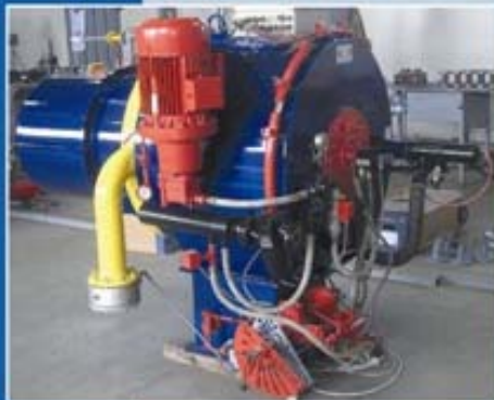
Kombinovani gorionik (gas - nafta) - konverzija / Combine burner (gas - oil) - conversion
