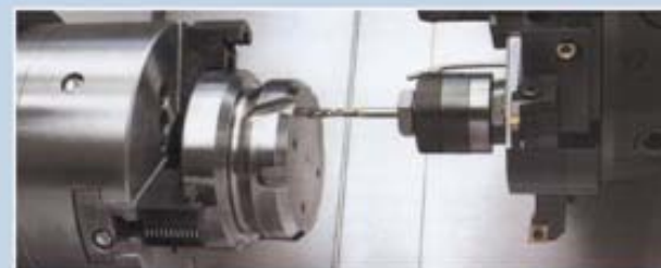
Mašinska obrada na RNC 400, C-osa (struganje, bušenje, glodanje) / Machining on RNC 400, C-axis (turning, drilling, milling)
