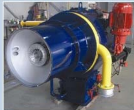
Kombinovani gorionik (gas - nafta) - konverzija / Combine burner (gas - oil) - conversion
